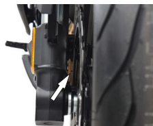
Frente: verificar as pastilhas de travão a partir da frente da pinça de travão
